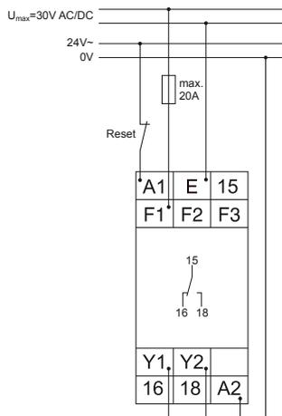
Messbereich 300V mit Powermodul 400V a.c. ohne Fehlerspeicher
