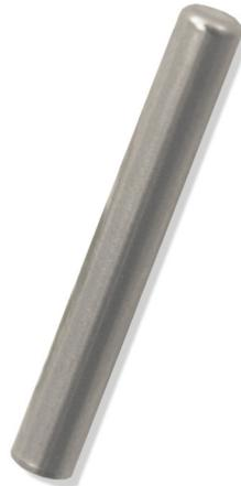
Einseitig geschlossene Schutzhülse 30 x 4 mm aus hochwertigem Edelstahl V4A, Werkstoffnummer 1.4571, für den Einbau und den Verguss von Temperatursensoren wie Pt100, PTC, NTC oder Halbleitersensoren, säurebeständig und für Lebensmittel geeignet, Innen  $\varnothing$  3,4 mm, geeignet für TO 92 Halbleitergehäuse oder PT100. Die Hülse bietet ausreichend Schutz für kritische Einsatzgebiete und die Montage in Tauchhülsen. Weitere Sonderlängen auf Anfrage.
