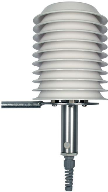
Speziell im Außenbereich müssen Feuchtefühler vor Sonnenstrahlung und Regen geschützt werden. Das Wetterschutzgehäuse ist eine durchdachte Lösung, um Sensoren optimal vor Witterungseinflüssen zu schützen, ohne die Messwerte zu verfälschen. Spezielle Werkstoffe, die für den Außeneinsatz geeignet sind sichern die dauerhafte Haltbarkeit.
