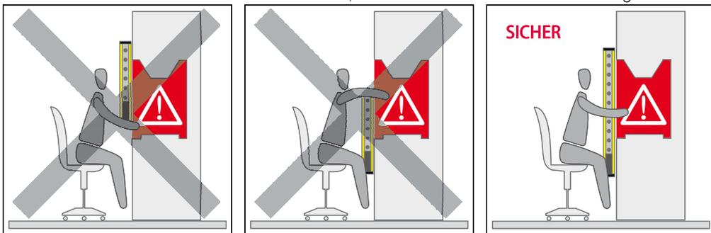
FIG. 12-16: ANORDNUNG DER SICHERHEITS-LICHTVORHÄNGE
