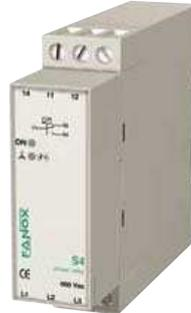
Schutz von Verbrauchern vor Veränderung der Phasenfolge sowie Phasenasymmetrie bzw. Phasenausfall. Ohne zusätzliche externe Versorgungsspannung, automatische Rücksetzung, Ausgangskontakt 1 Wechsler.
