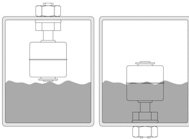
Bei Montage mit aufwärts gerichtetem Steigrohr kehrt sich das Schaltverhalten um.
