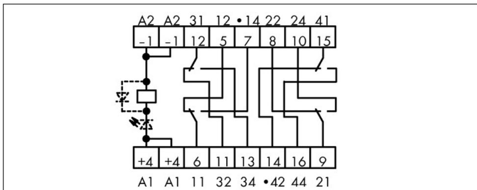
Druckansicht: Relaissockel; mit Freilaufdiode; Relais mit 4 Wechslern (4u); ohne Montagesockel;
