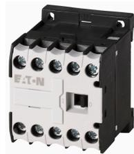
Hilfsschütz, 230 V 50 Hz, 240 V 60 Hz, S = Schließer: 4 S, Schraubklemmen, Wechselstrombetätigung
