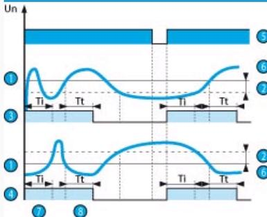
Wenn ein Betrieb "mit Speicherfunktion" eingestellt ist, öffnet das Relais beim Überschreiten des Schwellwertes und bleibt geöffnet. Um das Gerät zurückzustellen, ist die Spannungsversorgung zu unterbrechen.
