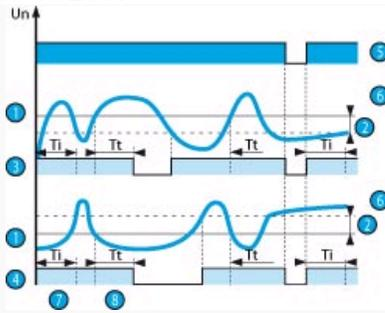
Wenn der überwachte Strom im Überstrombetrieb den eingestellten Schwellwert für eine längere als die frontseitig eingestellte Dauer (0,1 bis 3 s) überschreitet, öffnet das Ausgangsrelais, und die LED R erlischt. Während der Verzögerung blinkt diese LED.
