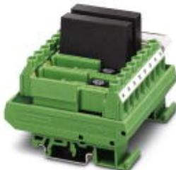
Interface-Modul, mit Stecksockel für 4 Solid-State-Relais, mit Rasthaken, mit Schraubanschluss, mit Leuchtanzeige und Sicherung, Ansteuerlogik minusschaltend
