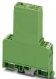
Leistungs-Solid-State-Relais, mit Leuchtanzeige und Schutzbeschaltung im Ein- und Ausgangskreis, Eingang: 24 V DC, Ausgang: kurzschlussfest, 10-30 V DC/max. 2 A
