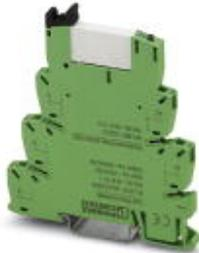
6,2 mm PLC-Relaiskomplettbaustein mit Push-in-Anschluss für Bahnanwendungen, Eingangsnennspannung 24 V DC, Bereich: 0,7 x U<sub>N</sub> bis 1,25 x U<sub>N</sub>, Temperaturklasse TX: -40 °C bis + 70 °C. Entspricht EN 50155, EN 50178, EN 61373, EN 50121 und IEC 62103.
