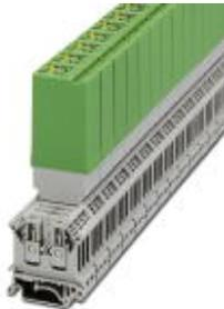
Steckbare Relais-Schnittstelle gegen Störeinflüsse auf der Steuerseite, mit fest eingelöteten Kleinschaltrelais, Kontakte (AgNi): mittlere bis große Leistungen, 1 Wechsler, Eingangsspannung 24 V AC/DC
