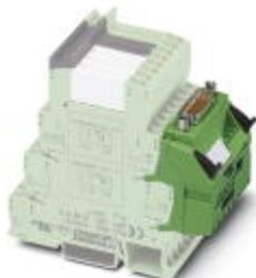
V8-OUTPUT-Adapter für acht 6,2 mm PLC Interfaces (1 Wechsler, etc./siehe „Ergänzende Produkte“). 15-polige D-SUB-Buchsenleiste, Ansteuerlogik: plusschaltend
