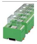
Relais-Modul, mit 1 Stecksockel für Industrierelais Größe 1, Kontakt: 4 Wechsler, Eingangsspannung 24-48 V DC, mit Leuchtanzeige, Freilauf- und Verpolschutzdiode
