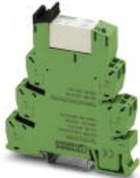
14 mm PLC-Relaiskomplettbaustein mit Push-in-Anschluss für Bahnanwendungen, Eingangsnennspannung 110 V DC, Bereich: 0,7 x U<sub>N</sub> bis 1,25 x U<sub>N</sub>, Temperaturklasse TX: -40 °C bis + 70 °C. Entspricht EN 50155, EN 50178, EN 61373, EN 50121 und IEC 62103.
