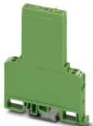
Eingabe-Solid-State-Relais, mit Leuchtanzeige und Schutzbeschaltung im Ein- und Ausgangskreis, Eingang: 12 V DC, Ausgang: 4 - 48 V DC/max. 100 mA
