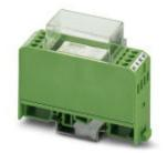
Relais-Modul, mit Kleinschaltrelais, mit integrierter NPN-Transistor-Ansteuerung, für niedrige Steuerströme, Kontakt (AgNi): mittlere bis große Leistungen, 1 Wechsler, Steuernennspannung 5 V DC
