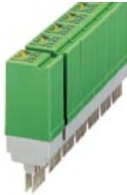
Relaisstecker, bestückt mit Kleinschaltrelais, Kontakte (AgNi+Au): kleine bis große Leistungen, 2 Wechsler, Eingangsspannung 24 V AC/DC, mit Leuchtanzeige, steckbar auf Grundklemmenblöcke
