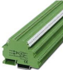
Eingabe-Solid-State-Relais, mit Gleichspannungsausgang-Gegentakt, Übertragungsfrequenz 100 kHz, mit Leuchtanzeige und Schutzschaltung im Ein- und Ausgangskreis, Eingang: 24 V DC, Ausgang: 14 - 30 V DC/50 mA
