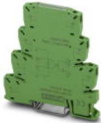
6,2 mm PLC-Solid-State-Relais mit Push-in-Anschluss für Bahnanwendungen, Eingangsspannung 110 V DC, Eingangsspannungsbereich von  $0,7 \times U_N$  bis  $1,25 \times U_N$ , Temperaturbereich von  $-25\text{ °C}$  bis  $+70\text{ °C}$
