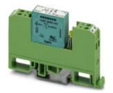
Relais-Modul, mit fest eingelötetem Kleinschaltrelais, Kontakte (AgNi): mittlere bis große Leistungen, 1 Schließer, Eingangsspannung 24 V DC, Aufbau 180° gedreht
