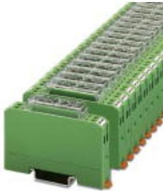
Inverter-Modul. Das Invertermodul invertiert die Signale masseschaltender NPN-Transistor-Ausgänge in plusschaltende PNP-Ausgänge, sowie auch Signale von PNP- in NPN-schaltende Signale.
