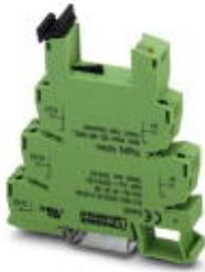
14 mm PLC-Grundklemmen mit Schraubanschluss und integriertem RCZ-Filter gegen Störströme bzw. Störspannungen auf der Steuerseite, Eingangsspannung 230 V AC (ohne Relais- oder Optokopplerbestückung)
