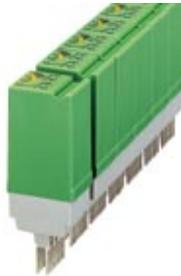
Relaisstecker, bestückt mit Kleinschaltrelais, Kontakte (AgNi+Au): kleine bis große Leistungen, 2 Wechsler, Eingangsspannung 230 V AC/DC, mit Leuchtanzeige, steckbar auf Grundklemmenblöcke
