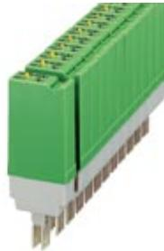
Relaisstecker, bestückt mit Kleinschaltrelais, Kontakte (AgNi): mittlere bis große Leistungen, 1 Öffner, Eingangsspannung 24 V AC/DC, mit Leuchtanzeige, steckbar auf Grundklemmenblöcke
