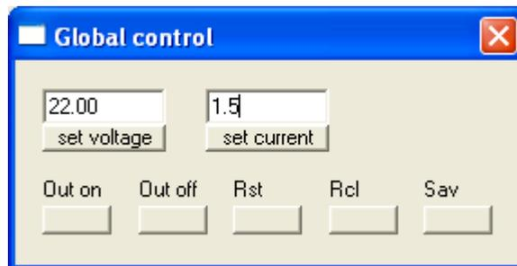
Das “Global control” Fenster kann über den Menüpunkt “Advanced -> Global Control” aktiviert werden. Dieser ist freigeschaltet, wenn mindestens ein Genesys Gerät angeschlossen ist, welches die “Global commands” unterstützt.
