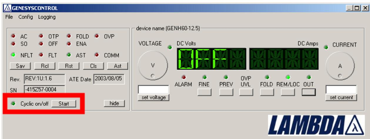
Wenn Sie den "Start" Button der Cyclic Funktion klicken, erscheint ein Dialog in dem Sie die Ein- und die Aus-Zeit für diese Funktion eingeben müssen. Nach erneutem Klicken des Start-Buttons schaltet GenesysControl den Ausgang des Genesys Gerätes zyklisch an und aus und zwar solange bis Sie den "Stop"-Button klicken.
