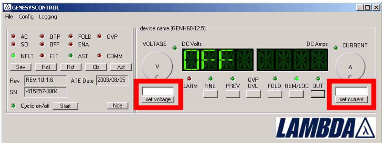
Unter den Drehreglern für Strom und Spannung befinden sich zwei Eingabefelder, die die direkte Eingabe eines Strom- oder Spannungswertes erlauben. Geben Sie einfach den gewünschten Wert ein und klicken den Button “set current” bzw. “set voltage” oder drücken Sie <ENTER>.
