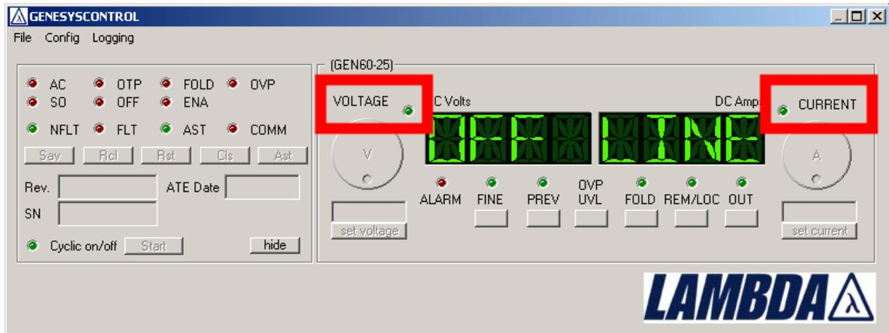
Die beiden LEDs zwischen Regler und Anzeige zeigen den aktuellen Modus des Ausgangs an. Wenn die LED neben dem Spannungsregler leuchtet, ist das Gerät im Constant-Voltage (cv) Modus. Wenn die andere LED leuchtet, ist das Gerät im Constant-Current (cc) Modus.
