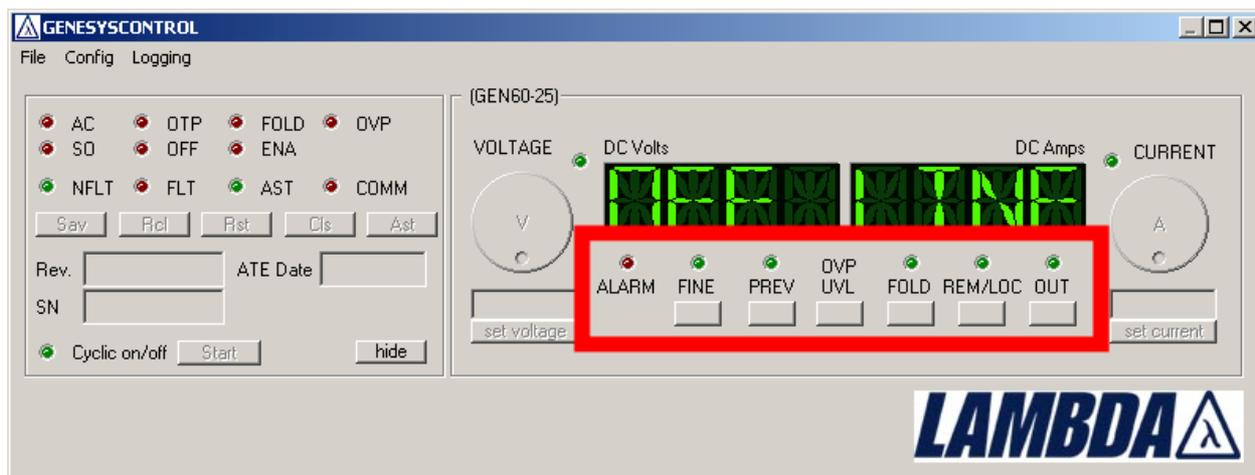
Folgende Buttons und LEDs befinden sich auf dem Front Panel:
