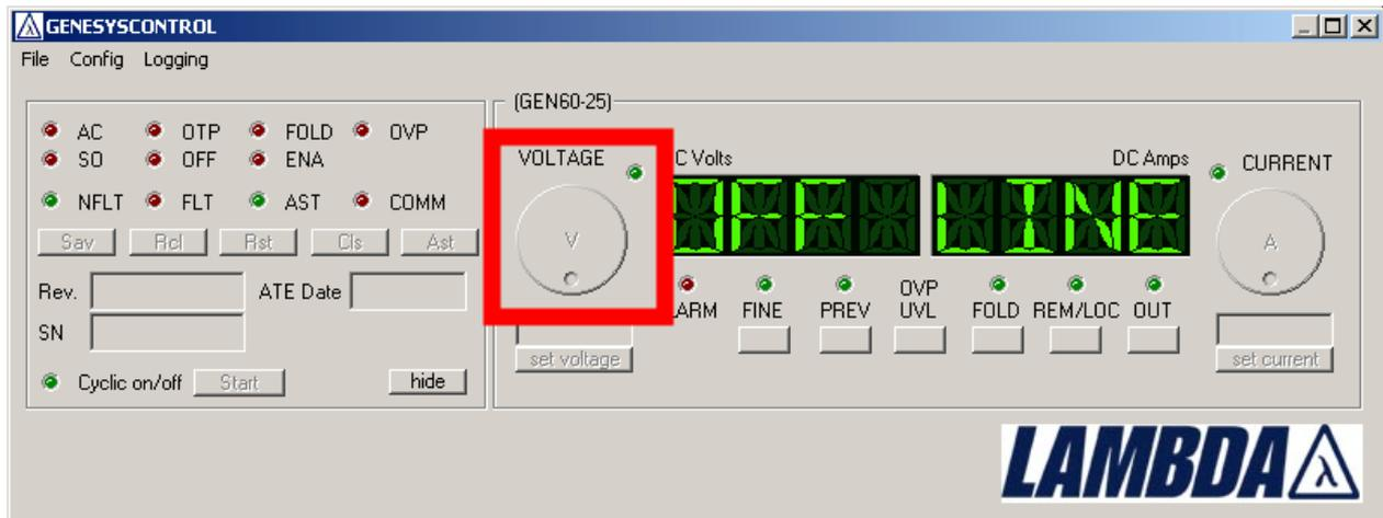
Drehen Sie am Regler, um die Spannung zu verändern.
