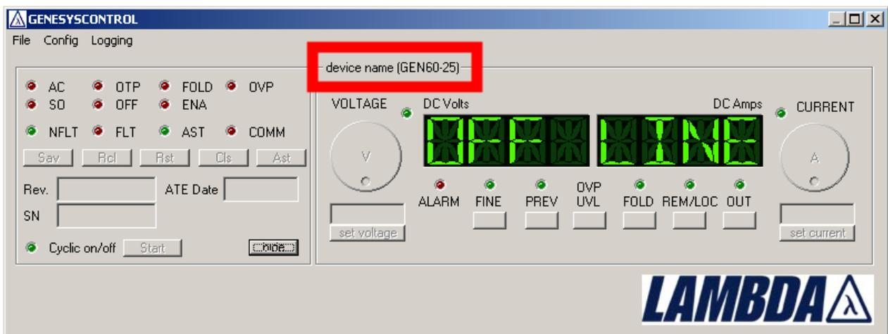
Am oberen Rand der Front Panels wird der Geräte-Name und -Typ angezeigt. Der Typ entspricht dem des Genesys Geräts, der Name kann in der Geräte-Konfiguration geändert werden.
