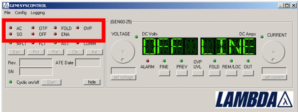
Die Alarm LEDs zeigen den Alarm Grund eines Genesys Gerätes an. Die folgenden Alarme können auftreten:
