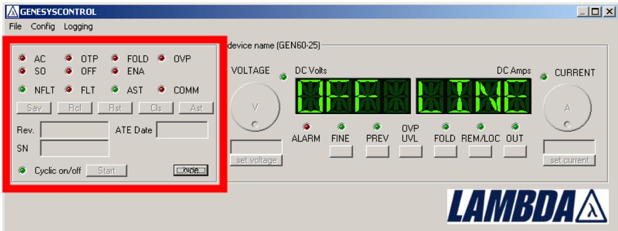
Die *Advanced Settings* bestehen aus vier Bereichen: den Status LEDs, den Alarm LEDs, den Kommando-Buttons und den Info-Feldern
