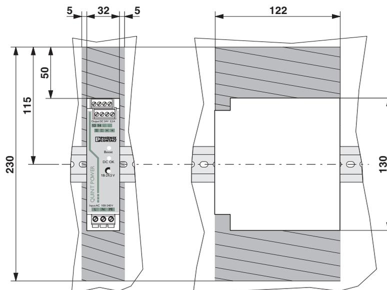
Schmale Einbaulage: Einbautiefe 125 mm (+ Tragschiene)
