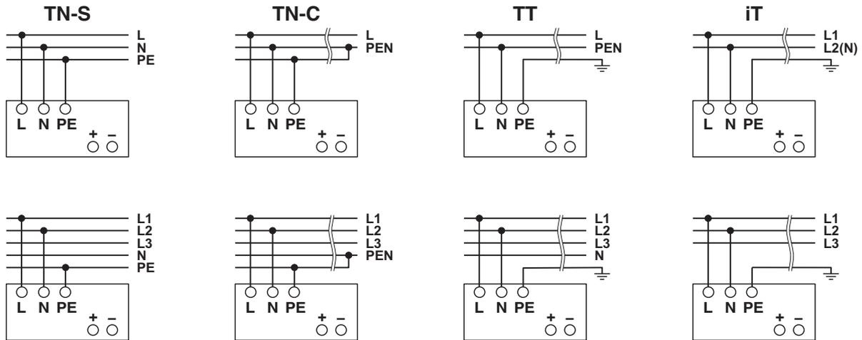
Der 100-...240-V-AC-Anschluss erfolgt über die Schraubverbindungen L, N und PE.
