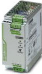
Primär getaktete QUINT Stromversorgung zur Tragschienenmontage, Eingang: 1-phasig, Ausgang: 24 V DC / 10 A, mit integrierter SFB Technology (Selective Fuse Breaking Technology), inkl. montiertem Universaltragschienenadapter UTA 107
