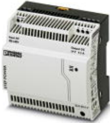
Tragschienen-Stromversorgung 24 V DC/4,2 A, primär getaktet, 1-phasig.
