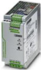
Primär getaktete QUINT Stromversorgung zur Tragschienenmontage, Eingang: 3-phasig, Ausgang: 24 V DC / 10 A, mit integrierter SFB Technology (Selective Fuse Breaking Technology), inkl. montiertem Universaltragschienenadapter UTA 107
