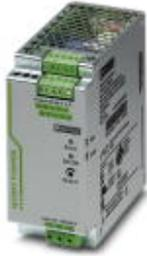
Primär getaktete QUINT Stromversorgung zur Tragschienenmontage, Eingang: 1-phasig, Ausgang: 48 V DC / 5 A, mit integrierter SFB Technology (Selective Fuse Breaking Technology), inkl. montiertem Universaltragschienenadapter UTA 107
