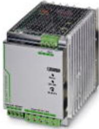
Primär getaktete QUINT Stromversorgung zur Tragschienenmontage, Eingang: 3-phasig, Ausgang: 24 V DC / 40 A, mit integrierter SFB Technology (Selective Fuse Breaking Technology), inkl. montiertem Universaltragschienenadapter UTA 107
