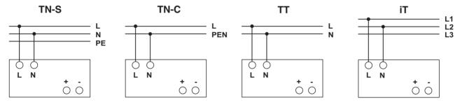
Der Anschluss für 100 V AC ... 240 V AC erfolgt über die Schraubverbindungen L und N. Das Gerät kann an 1-phasigen Wechselstromsystemen oder an zwei Außenleitern von Drehstromsystemen (TN-, TT- oder IT-Netz nach VDE 0100-300/IEC 60364-3) mit Nennspannungen 100 V AC ... 240 V AC angeschlossen werden.
