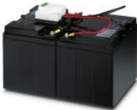
Energiespeicher, Blei-AGM, VRLA-Technologie, 24 V DC, 38 Ah, automatische Erkennung und Kommunikation mit der QUINT UPS-IQ
