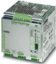
Unterbrechungsfreie Stromversorgung mit IQ Technology 1AC/1AC/500 VA. Für 120 V AC/230 V AC Anwendungen. Gibt jederzeit Auskunft über Ladezustand, Restlaufzeit und Lebensdauer des Akku-Modules und steigert so die Anlagenverfügbarkeit.
