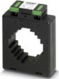
Aufsteckstromwandler, Primärstrom 800 A AC; Sekundärstrom 5 A AC; Genauigkeitsklasse 1; Bemessungsleistung 10 VA
