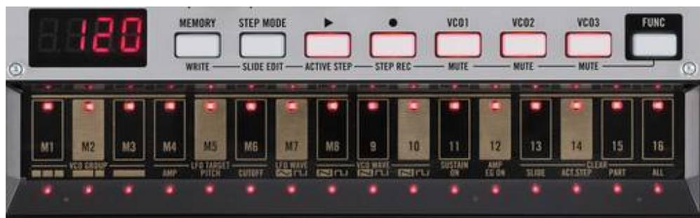
Mit diesem Step Sequencer kann man Parts spielerisch editieren und improvisierend hinzufügen oder entfernen. Man kann Noten über die 16 Step-Tasten intuitiv eingeben und gleichzeitig das Notentiming innerhalb des Taktes visuell überwachen. Mit der Touch Panel-Tastatur lassen sich pro Oszillator separate Phrasen in Echtzeit aufzeichnen, um sie in acht Sequence Pattern zu speichern und jederzeit wieder abzurufen.
