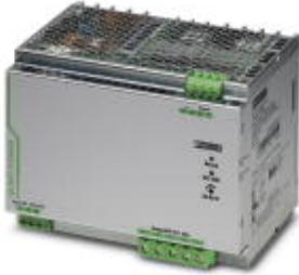
Primär getaktete QUINT Stromversorgung zur Tragschienenmontage, Eingang: 1-phasig, Ausgang: 48 V DC / 20 A, mit integrierter SFB Technology (Selective Fuse Breaking Technology), inkl. montiertem Universaltragschienenadapter UTA 107
