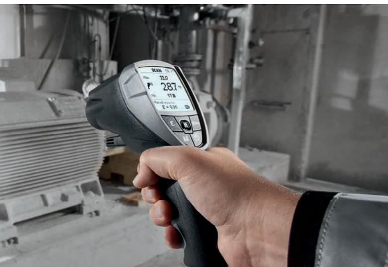
**Praktisch**, weil Messprotokolle noch vor Ort erstellt und später am PC ausgewertet werden können. **Intelligent**, weil die integrierte Emissionsgradtabelle eine deutlich einfachere Messung ermöglicht. **Vielseitig**, da die Serie von der einfachen Stichproben- bis hin zur Dauermessung einsetzbar ist. **Und dennoch einfach**, weil auch ungeschulte Mitarbeiter qualifiziert Messungen durchführen können.
