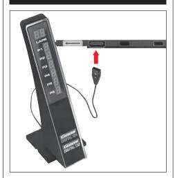
Der Position Tower wird an entsprechender Stelle an der Adapter Unit angeschlossen, diese kann an einer beliebigen Stelle des Bahnlayouts platziert werden.
