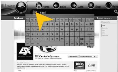
Mit einem separat erhältlichen 3G-USB-Stick und einer aktiven SIM-Karte (3G/UMTS) ist es möglich, die „Internet“-Funktion zu verwenden. Stecken Sie dazu den Stick an den USB-Anschluss des Geräts und folgen den Installationsanweisungen des jeweiligen Sticks. Halten Sie dazu die Zugangsdaten für den Internetzugang bereit.
