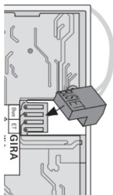
2. Schieben Sie den Steckverbinder auf die Kontakte der Geräteplatine auf der Rückseite der Wohnungsstation auf.
