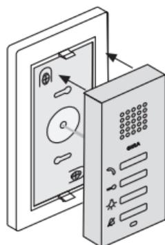
3. Schließen Sie jetzt die Wohnungsstation, indem Sie das Gehäuseoberteil auf die Montageplatte aufsetzen und einrasten.
