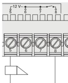
Relaisausgang zur Ansteuerung eines Türöffners (8 - 12 V AC, max. 1,6 A).
