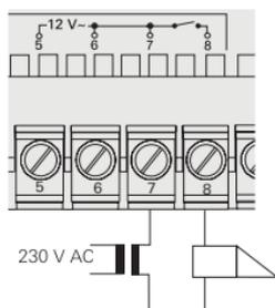
Ein Türöffner mit anderen elektr. Werten (z.B. sehr niederohmig oder 24 V) kann mit zusätzlicher Spannungsversorgung an den Relaiskontakt angeschlossen werden.
