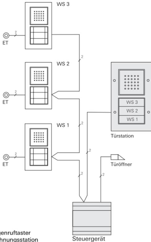
Die Lösung „Durchschleifen“ hat den Vorteil, dass bei späterer Nachrüstung von Videokomponenten keine Videoverteiler benötigt werden.
