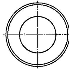
Bezeichnung einer Scheibe Form A oder B (nach Wahl des Herstellers), von Lochdurchmesser  $d_1 = 8,4$  mm, aus Stahl (St):
