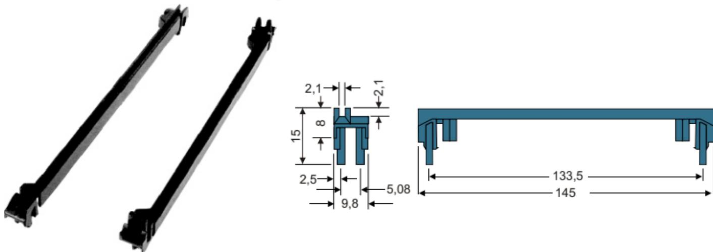
*Karten-Führungsschienen werden in Baugruppenträger nach DIN41494 eingesetzt, um den eingeschobenen Flachbaugruppen Führung und Halt zu bieten. Die Montage erfolgt durch Einstecken in gelochte Trägerprofile 1 und 2.*
