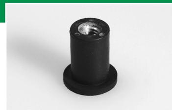
Die elastische, schwingungsdämpfende Verbindung für empfindliche Werkstoffe. Die Blindmutter ist rundum gegen Korrosion geschützt, ölbeständig und elektrisch nicht leitend. Sie wird von einer Seite eingesetzt. Bei der einfachen Schraubmontage formt sich der elastische Körper zu einem sicheren, dichten Schließkopf. In Sacklochbohrungen preßt sich die Blindmutter durch Reibschluß fest an die Bohrlochwandung.
