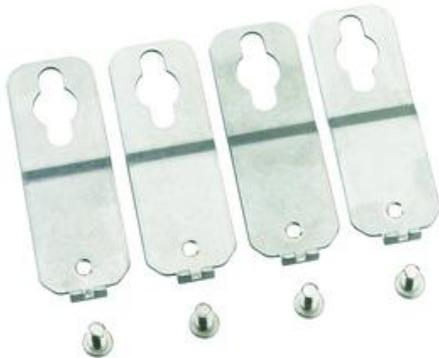
Zur Montage einzelner Gehäuse oder kleiner Anlagen an ebenen Wandflächen, kann am Unterkasten im Winkel 0°, 45° oder 90° befestigt werden, Wandabstand 7 mm, Material Edelstahl
