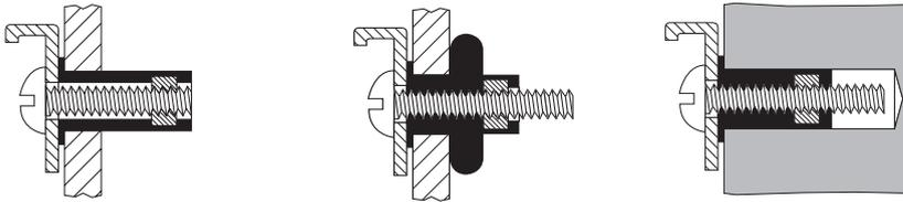
Die elastische, schwingungsdämpfende Verbindung für empfindliche Werkstoffe.
