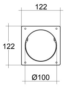
Teleskop-Rundrohrmauerkasten, NW 100 m. RSK, weiß N37824 Stand 26.11.2010 Material: Kunststoff
