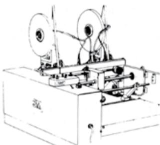
Dieses Gerät ermöglicht bei Verwendung der Planklebeköpfe TE-1635 das exakte in Länge und Lage definierte Auftragen von einseitigen und doppelseitigen Klebebändern.
