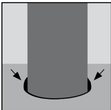
Die Klebstoffrollen werden wie abgebildet gelagert – dadurch wandert der Klebstoff an den Schnittkanten heraus; einige Rollen kleben sogar auf dem Untergrund fest.
