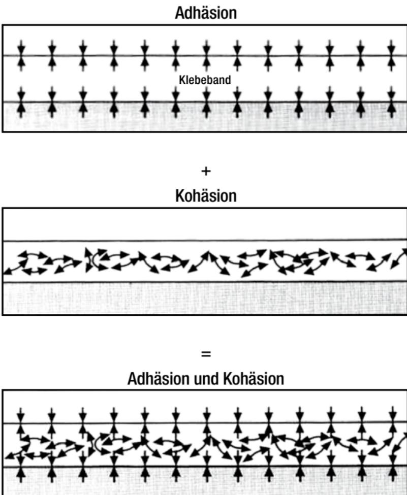
Als **Adhäsion** werden die Anziehungskräfte bezeichnet, die an den Grenzflächen zwischen gleichen und verschiedenartigen Stoffen, beispielsweise der Klebstoffoberfläche und der zu klebenden Fläche, zur Wirkung kommen. Diese Kräfte bedingen die Haftung zwischen den Werkstoffen.
