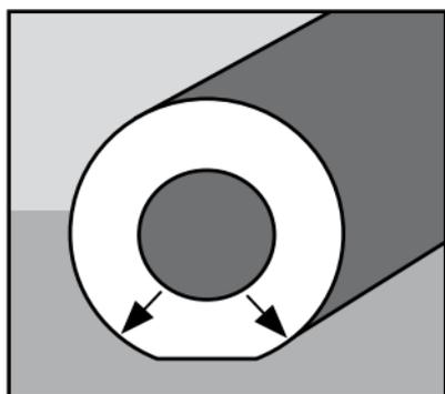
Die Klebstoffrollen werden wie abgebildet gelagert. Nach kurzer Zeit tritt eine Deformation auf, da die Rollen durch ihr Eigengewicht zusammengedrückt werden.
